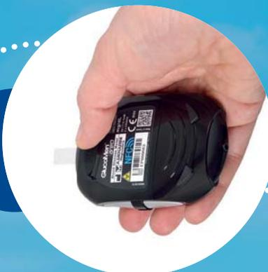
Pritisnite tipku za izbacivanje i na primjeren način odstranite mjernu traku.
